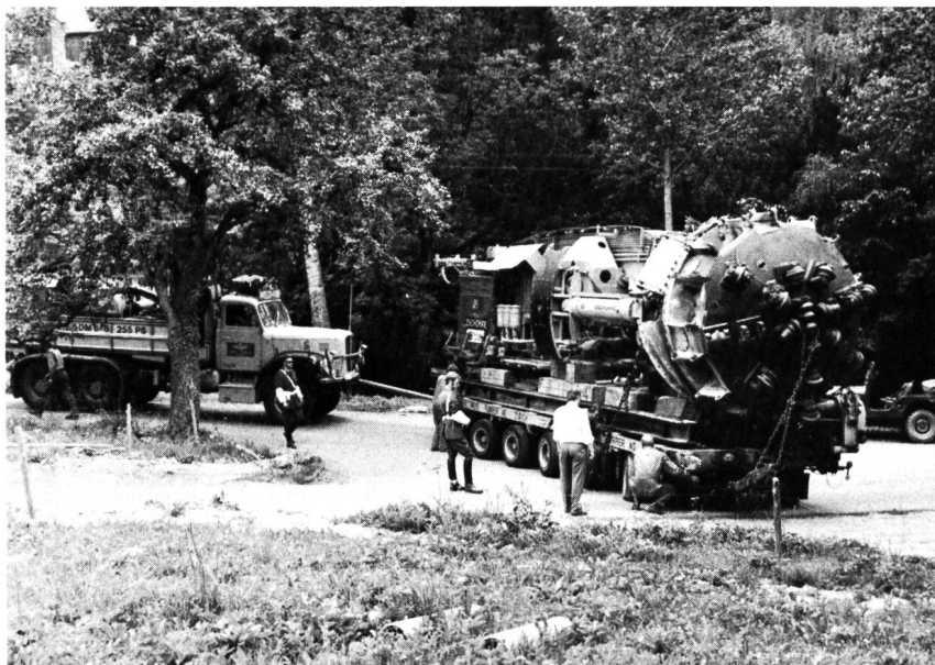
Bild 5. Stollenbohrmaschinen auf dem Weg zur Baustelle.
