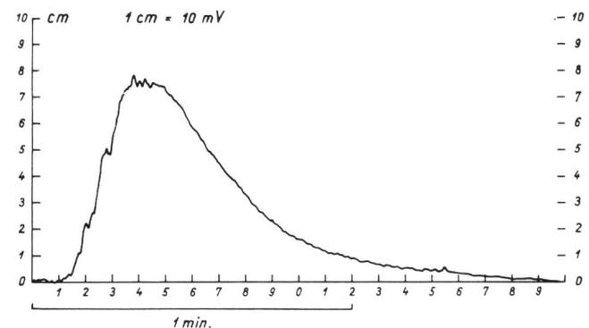
Figure 2. Courbe d'activité de l'ion  $\text{Na}^+$  enregistrée par potentiographe portatif. L'irrégularité de la courbe traduit la mauvaise répartition du sodium dans le cours d'eau. Le contrôle in situ et en continu permet de détecter l'insuffisance de l'homogénéisation de la substance injectée.
