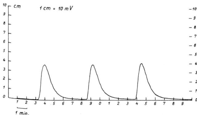
Figure 1. Courbes d'activité de l'ion  $\text{Na}^+$  enregistrées par potentiographe portatif lors de trois jaugeages successifs exécutés dans des conditions identiques (Méthode par intégration). Les courbes traduisent la parfaite reproductibilité de la méthode.
