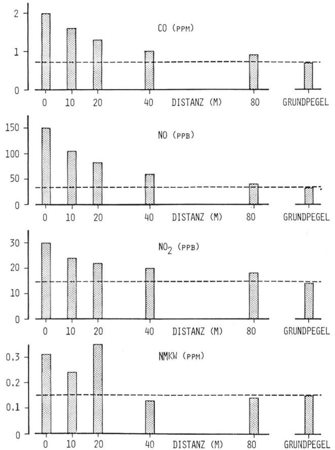
Bild 3c. Autobahn (Oensingen). Die Konzentrationen von CO, NO und NO<sub>2</sub> sind auch noch in 80 m Distanz höher als der lokale Grundpegel, weil die Autobahn in weitem Umkreis die einzige Quelle von Luftfremdstoffen ist; die Kohlenwasserstoff-Werte (NMKW) sind durch landwirtschaftliche Quellen beeinflusst.
