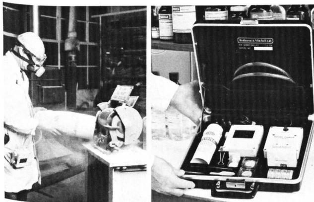
mit einem Fixiermittel besprüht. Eine einfache Analyse erlaubt sodann, die Luftverschmutzung festzustellen. Die ganze Ausrüstung kann in einem widerstandsfähigen Kofferchen verstaut werden. Rotheroe and Mitchell Ltd.
