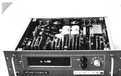
Bild 2. Akustisches Strömungsmessgerät Flora (Deckel entfernt).
