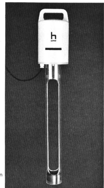
Bild 8. Selbstausgleichendes Referenz-Echolot, Kopf mit Schallwandler, Referenzstrecke in halbgeöffnetem Rohr mit ringförmigem Referenzkörper.
