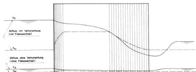
Bild 1. Venturikanal, Abflusshöhen und kritische Tiefen mit und ohne Fließwechsel.
