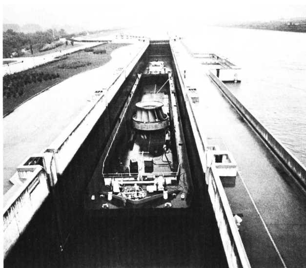
Bild 7. Die Schleuse der Staustufe Saint-Vallier. Das Spezialschiff Tisve-Rhône für schwere Stückgüter trägt den auf der Achse Rhone-Saône vorhandenen Umschlagseinrichtungen Rechnung. Hier wird ein Turbinenrad von 145 t Gewicht transportiert. Geladen wurde diese Fracht im Hafen Edouard-Herriot für die Firma Neyrpic in Grenoble; Bestimmungsland ist Brasilien. Solche schwere und sperrige Werkstücke wären auf dem Landweg nur mit Schwierigkeiten zu transportieren. Mai 1977.
