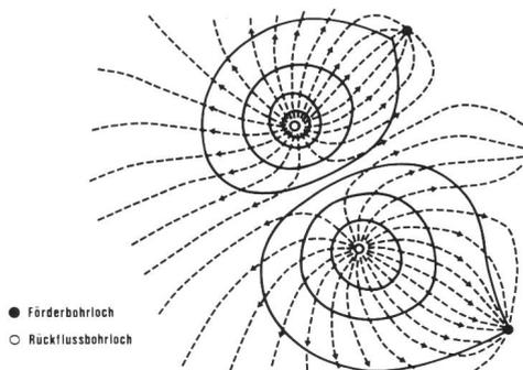
Bild 4. Die Abkühlung des Wärmereservoirs während der Ausbeutung.
