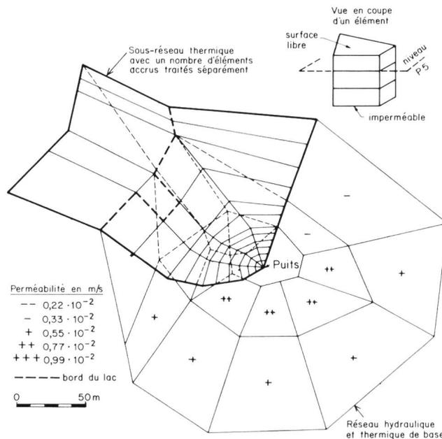
Figure 20. Nappe de Colombier-Robinson. Coupe horizontale au niveau  $P_5$  du réseau d'éléments avec jonction d'un sous-réseau destiné à améliorer la précision des solutions numériques. Une augmentation de la densité des éléments dans la zone du puits (non représentée) est également réalisée (d'après Favrod, Jamier, et Menjot dans [3]).
