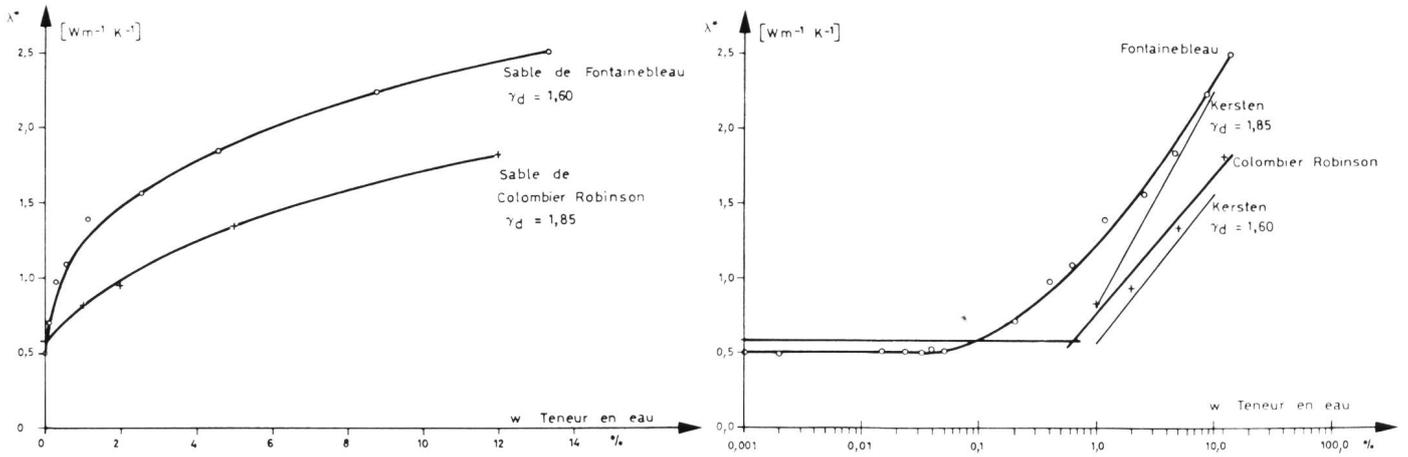
Figure 13. Conductivité thermique  $\lambda$  en fonction de la teneur en eau ( $\gamma_d$  = densité apparente).
