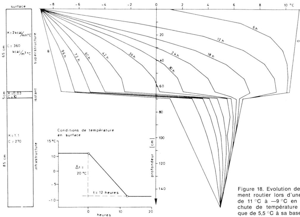
Figure 18. Evolution de la température dans un soubassement routier lors d'une chute de la température de l'air de 11 °C à -9 °C en 12 heures. Au toit de l'isolant la chute de température est de 18 °C, alors qu'elle n'est que de 5,5 °C à sa base (Inédit dans [3]).
