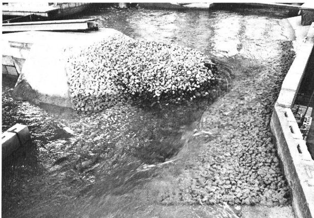
Bild 8. Seitliche Schüttung mit 4-t-Material, raue Uferoberfläche.
