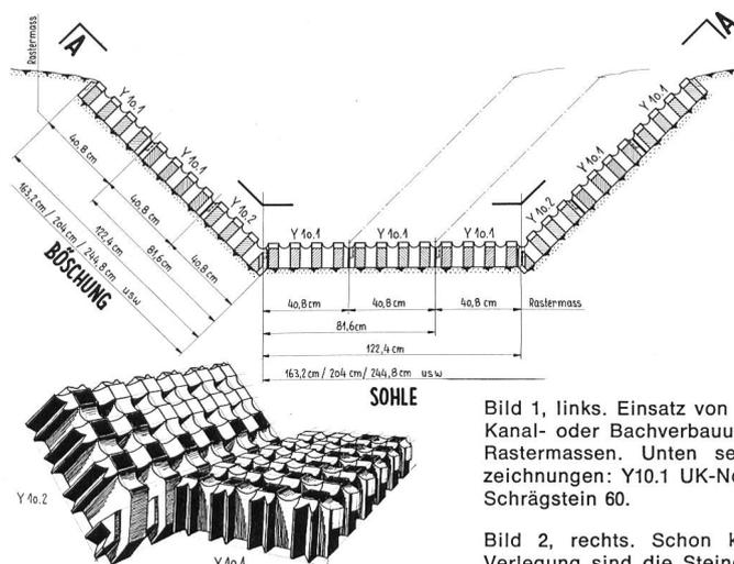
Bild 1, links. Einsatz von UK-Steinen bei einer Kanal- oder Bachverbauung. Oben Schnitt mit Rastermassen. Unten seitliche Ansicht. Bezeichnungen: Y10.1 UK-Normalstein, Y10.2 UK-Schrägstein 60.
