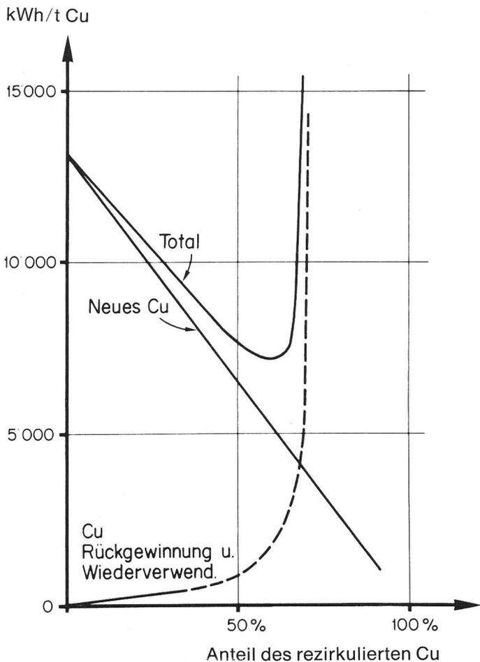
Bild 2. Energieaufwand für die Herstellung einer Tonne Kupfer in Abhängigkeit des prozentualen Anteils an recykliertem Kupfer (nach Stumm und Davis 1974 [1]).
