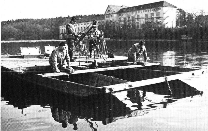
Bild 6. Bootsfluss mit Personal und Einrichtung bei der Aufnahme eines Temperaturquerschnitts im Aareknie. Im Hintergrund die hydraulische Zentrale Beznau.
