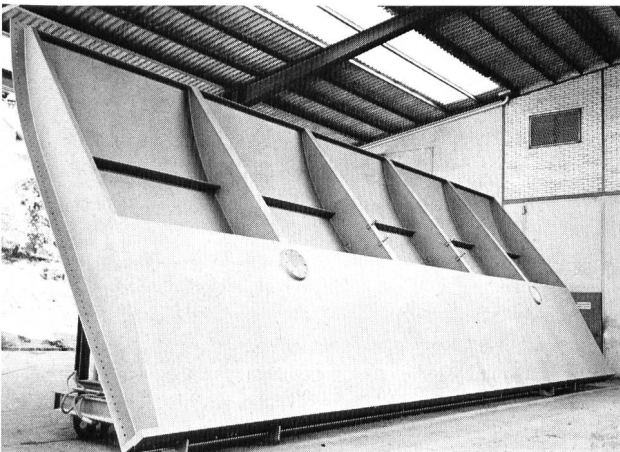
Bild 1. Stauklappe für das Stauwehr Thun im Korrosionsschutzwerk, 1960.
