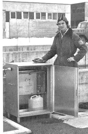
Die Grundausrüstung ist mit einem spritzwassergeschützten Kunststoffgehäuse, vorgesehen für Wandmontage (Bild). Diese Einheit lässt sich als Baustein in Schränke für Aussenaufstellung einbauen. Diese sind wetterfest, beheizt, zur Kühlung von Proben vorgesehen, oder mit 6, 12 oder 24 Probeflaschen ausgerüstet.
