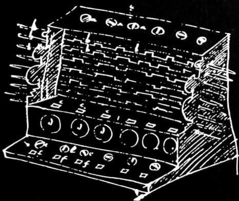
Das maschinelle Rechnen wurde bereits 1623 von Wilhelm Schickard versucht. Seine genial konstruierte Rechenmaschine erlaubte die Durchführung der vier Grundoperationen und besass speichernde Register.
