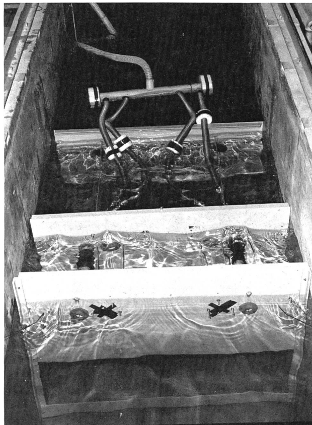
Bild 9. Erster Prototyp des Wellennutzers von Farley im Wellenkanal der Versuchsanstalt für Wasserbau, Hydrologie und Glaziologie an der ETH Zürich (Bild VAW).
