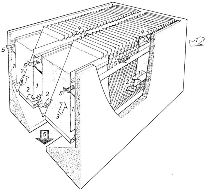
Bild 1. Schematische Darstellung eines Lamellenklärsers. 1 Rohwasserkanal, 2 Eintritt Rohwasser in Lamellenzelle, 3 Aufwärtsströmung des Wassers zwischen den Lamellen, 4 Überlaufrinne Reinwasser, 5 Reinwasserkanal, 6 Schlammfänger.
