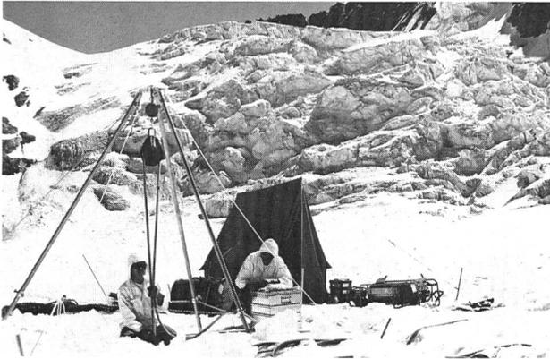
Bild 2. Thermische Tiefbohrung auf dem Brenay-Gletscher. Rechts vom Zelt Durchlauferhitzer und Pumpen. (Aufnahme H. Röhliberger, 23. 7. 1977)
