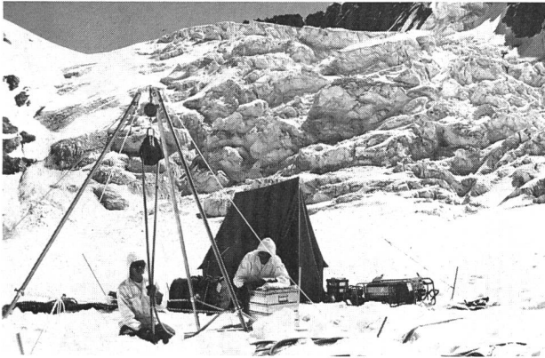
Bild 2. Thermische Tiefbohrung auf dem Brenay-Gletscher. Rechts vom Zelt Durchlauferhitzer und Pumpen. (Aufnahme H. Röhliberger, 23. 7. 1977)
