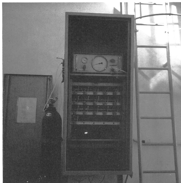
Bild 4. Messzentrale für 16 Peronwasserdruckgeber in der Staumauer Zervreila.
