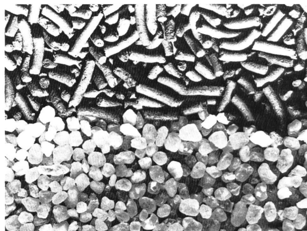
Bild 41. Zweischicht-Aktivkohlefilter. Unten die Stützsicht aus Quarzsand, Durchmesser 1 bis 2 mm, oben die Aktivkohle.
