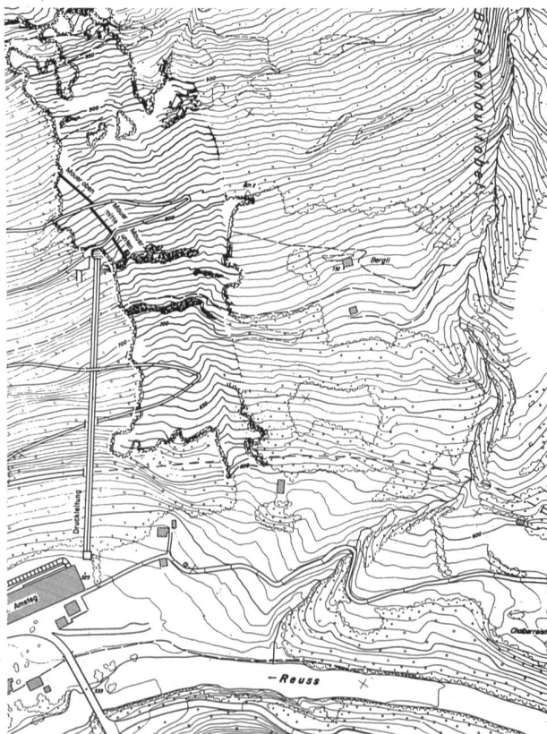
Bild 2, rechts. Situation mit den Ablenkmauern.
