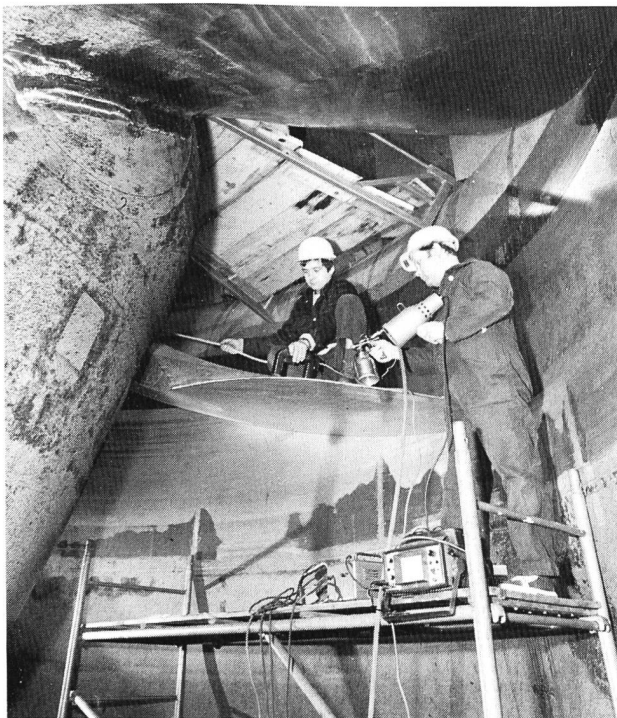
Bild 4. MT- und UT-Prüfung in einer Kaplanmaschine im Kraftwerk Schaffhausen. MT: Magnetisierungsprüfung; UT: Ultraschallprüfung. Werkfoto + GF+
