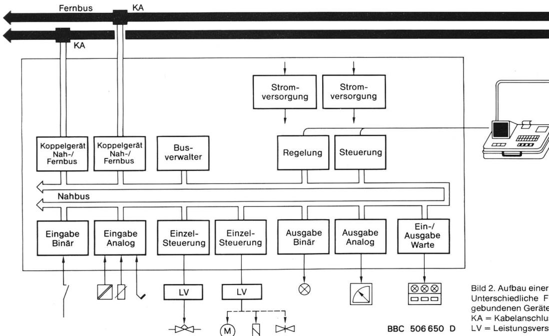
Bild 2. Aufbau einer Procontrol P-Station. Unterschiedliche Funktionen sind zweckgebundenen Geräten zugeordnet. KA = Kabelanschluss für den Fernbus; LV = Leistungsverstärkung.
