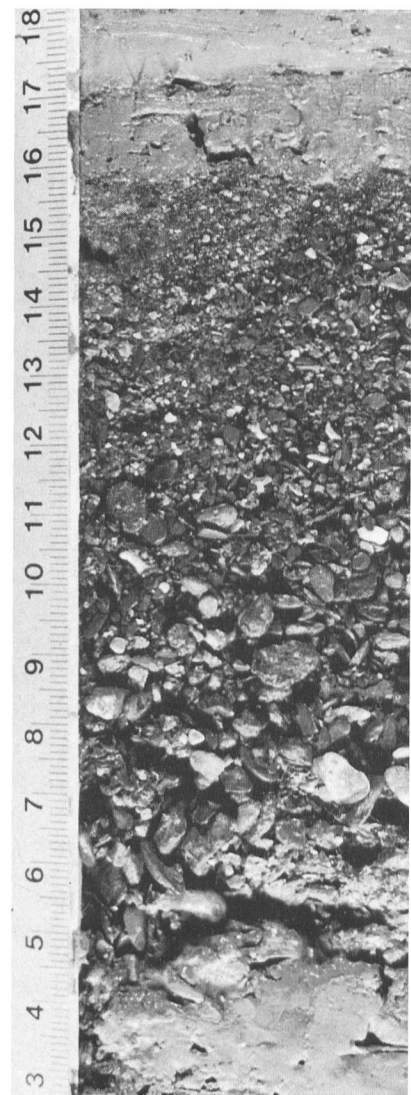
Bild 4. Kiesige Zwischenschicht in den überwiegend feinkörnig aufgebauten Sedimenten der zentralen See-Ebene. Solche Einschaltungen dokumentieren murgangartige Ereignisse in den seitlich einmündenden Wildbächen (cm-Massstab).
