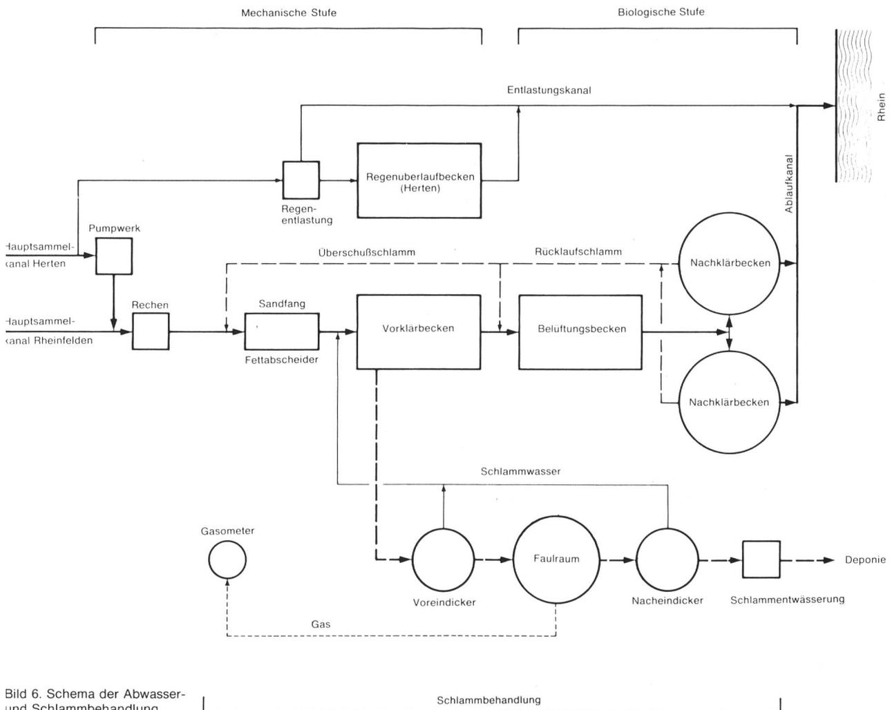
Bild 6. Schema der Abwasser- und Schlammbehandlung.
