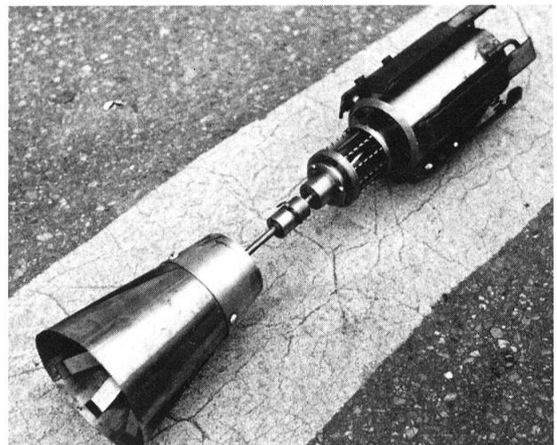
Schleudermaschine für Kunststoffbeschichtung in Rohren mit Glätter.
