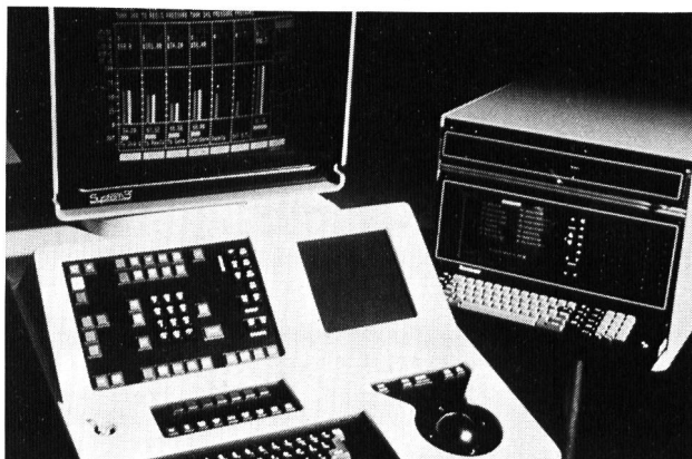
Bild 1. Bedienstation für das Prozessleitsystem RS3.
