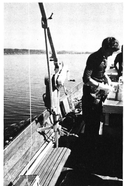
Bild 4, rechts. Zuverlässige Seearbeit erfordert entsprechend brauchbare Hilfsmittel. Auch hier darf das Arbeitsprogramm (physikalische Messungen mit teilweise schweren Geräten, Wasserproben mit z.T. grossen Volumen, Organismenfang mit langen Fangnetzen, Sedimentproben von beträchtlichem Ausmass usw.) nicht durch die vorhandenen Hilfsmittel eingeschränkt sein, vielmehr sollen diese die Anforderungen des Programms erfüllen. Unser Bild: Arbeitsplatz auf dem Forschungsboot «Forch» der EAWAG auf dem Greifensee.
