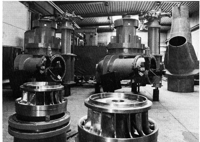
Francis-Kompaktturbinen 84 kW, Peru
