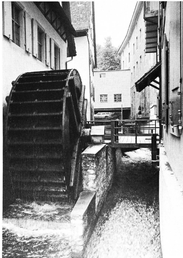
Sogenannter Hinterer Teich, ein Arm des St.-Alban-Teichs, mit unterschlächtigem, hölzernem Wasserrad (4,70 m Durchmesser, 36 Schaufeln). Es treibt ein Stampfwerk im Schweizerischen Papiermuseum an. (Foto E. Golder jun.)
