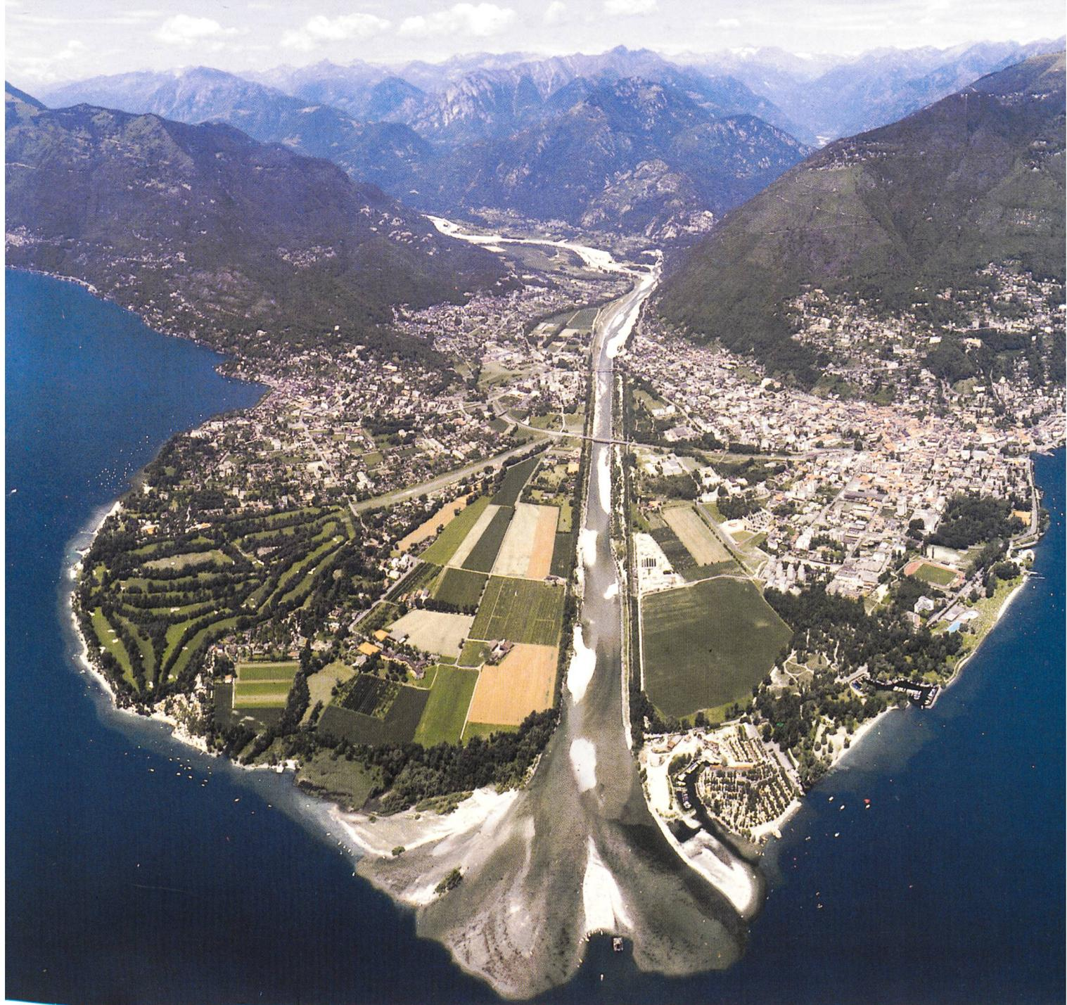
Das Delta der Maggia im Lago Maggiore aus 1400 m Flughöhe, aufgenommen am 15. Juli 1981 mit Ascona (links) und Locarno (rechts). Wiederholte Seegrundvermessungen ermöglichen eine Abschätzung der von der Maggia aus dem Einzugsgebiet verfrachteten Erosionsschutts. Aufgrund der neuesten Vermessung von 1984 beziffert sich der mittlere jährliche Eintrag seit 1952 auf rund 325 000 m<sup>3</sup>.
