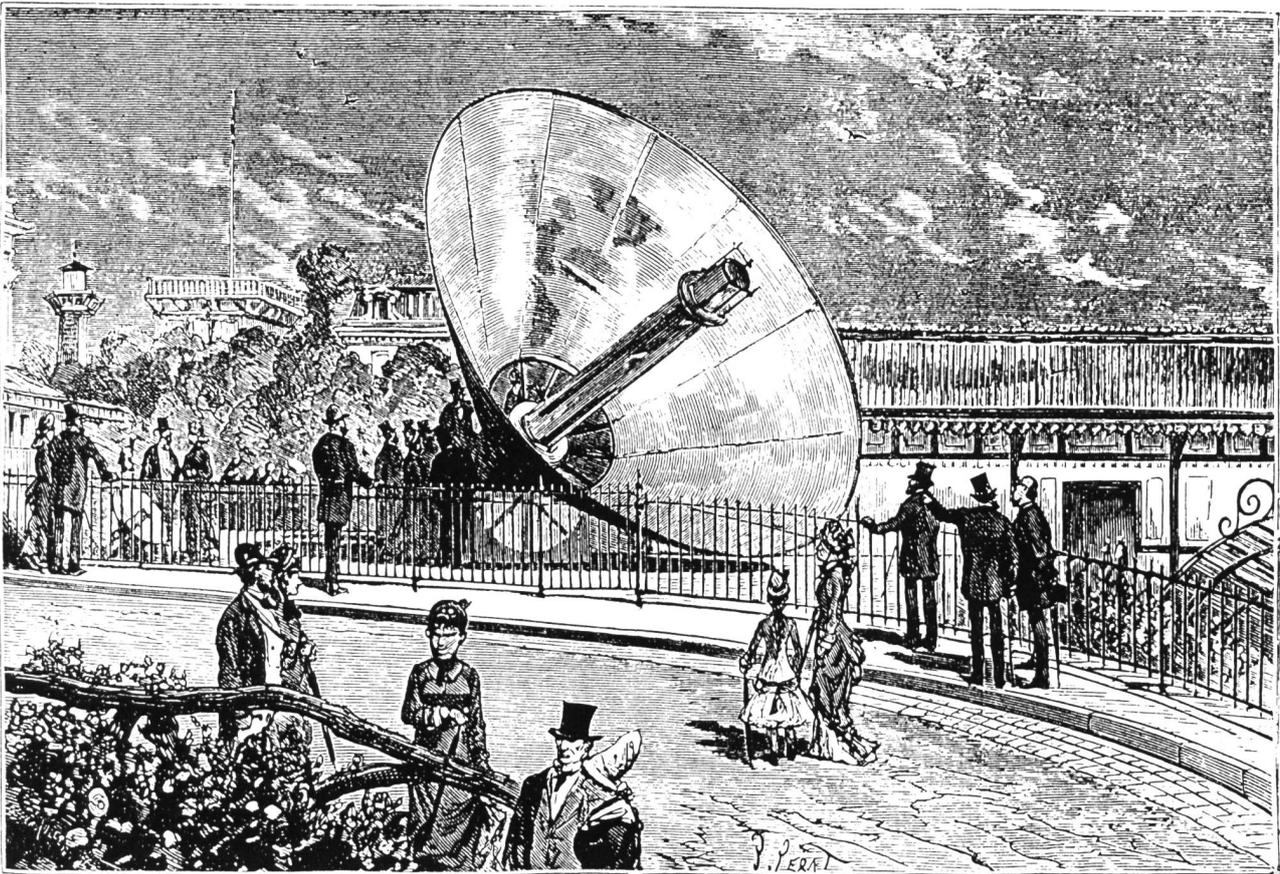
Mouchots grosser Solarapparat auf der Weltausstellung 1878 in Paris hatte einen konischen Brennspiegel von fünf Meter Durchmesser. Mit dem erzeugten Dampf trieb Mouchot verschiedene Pumpen und eine Eismaschine an.
