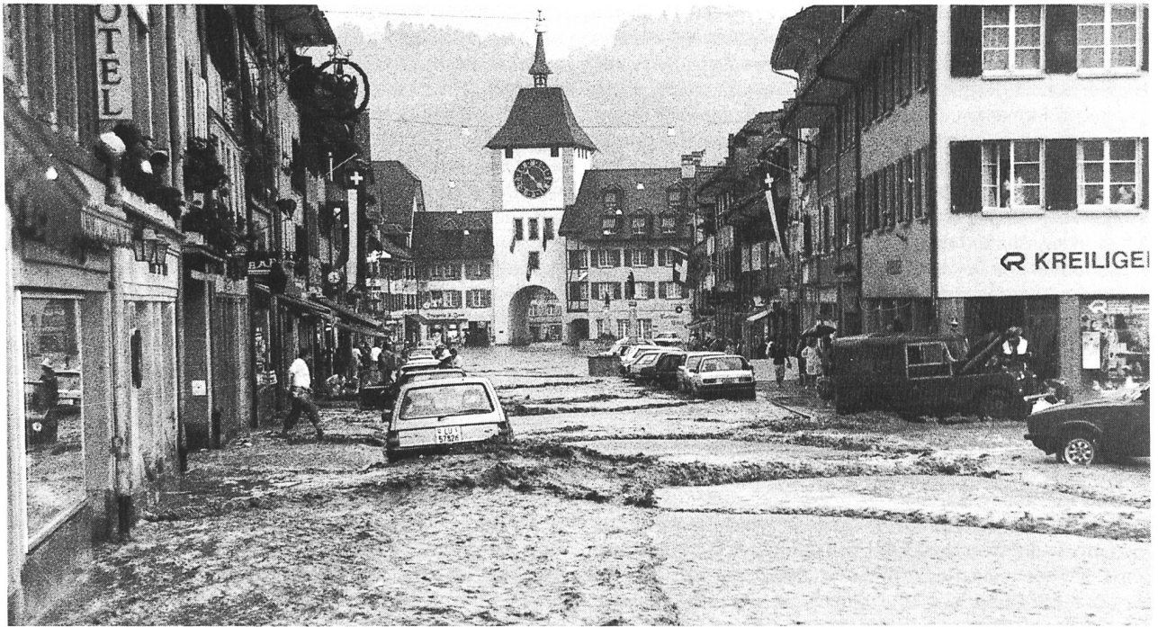
Bild 4. Das Städtchen Willisau/LU während des Unwetters vom 16. Juni 1988. Interessant der schiessende Abfluss mit den Stosswellen auf der überschwemmten Strasse. Das in diesem Jahr schadenreichste Ereignis hinterliess im Kanton Luzern Sachschäden von mindestens 50 Millionen Franken und forderte ausserdem ein Menschenleben. (Foto: Werner Burri, Willisau)
