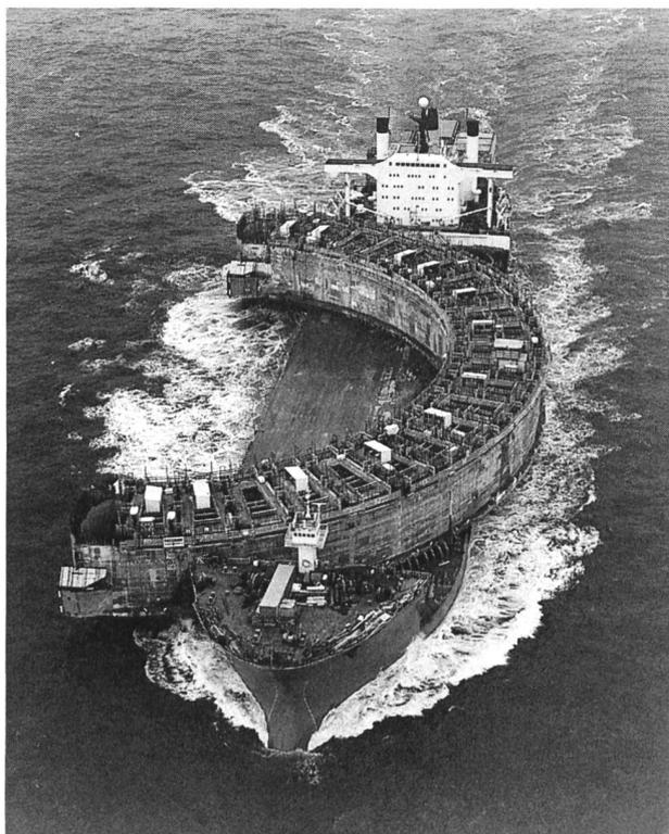
Bild 5. Transport eines der beiden Wandteilstücke mit einem Spezialschiff von Rotterdam nach Norwegen.
