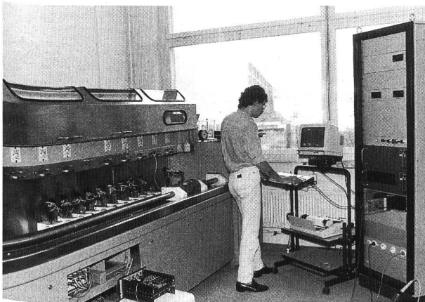
GWF-Mitarbeiter am Heisswasserzählerprüfstand.
