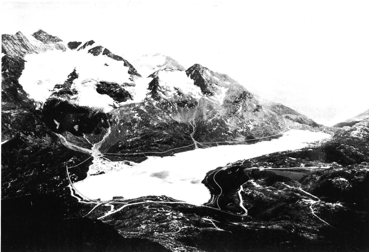
Bild 1. Der Lago Bianco von Süden gesehen. Rechts das Gambrena-Delta, das überstaut wird. Eingezeichnet sind die geplanten Staumauern und die Uferlinie des um 25 m höher zu stauenden Sees. Im Vordergrund ist die Bernina-Pass-Strasse zu erkennen.
