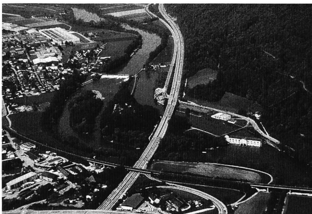
Bild 1. Das Kraftwerk Ruppoldingen, eines der ersten grösseren Kraftwerke der Schweiz. Links oben das Stauwehr, anschliessend rechts der Kanal, wie er damals bei Kraftwerken üblich war. Im alten Aarelauf unterhalb des Stauwehrs liegen die Ruppoldingen Inseln.
