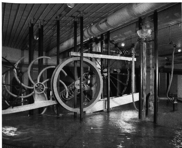
Bild 1. Die Gesetze der Wasserförderung und Wasserkraft: mit Schöpfrad, Archimedischer Schraube, Kolbenpumpe und Segnerrad kommt man ihnen auf die Spur.
