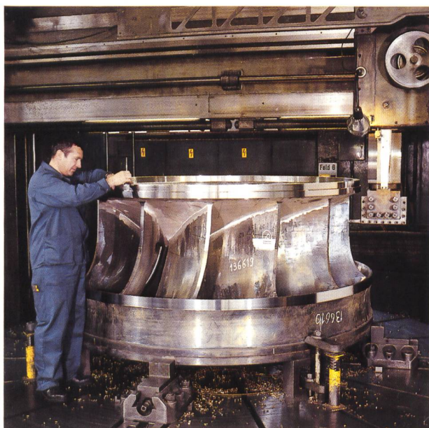
Bild 6.7. Bearbeitung eines Franciscrades im Werk. Der Austrittsdurchmesser des Laufrades beträgt 2,40 m, das Gewicht 5,50 t. Die Laufräder verarbeiten eine Wassermenge von je 44 m 3 /s. (Aufnahme Sulzer-Escher Wyss)
