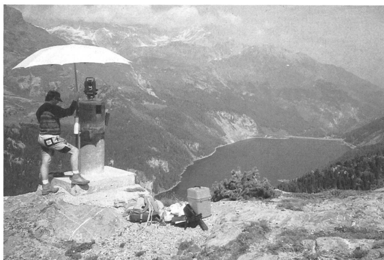
Figure 3.7. Un pilier. Bild 3.7. Pfeiler.
