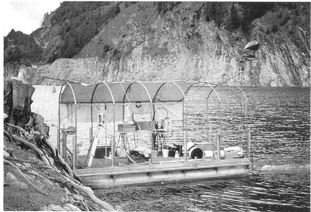
Figure 2. Ponton 2 t, équipé avec antenne de positionnement et protection contre la pluie. (Photo Bureau Martin)
