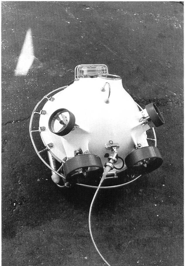
Figure 6. Caméra sous-marine: vue depuis dessus. On distingue l'ombilic, deux moteurs de translation et deux moteurs de poussée verticale. A l'avant, le dispositif d'éclairage et le flash. (Photo Bureau Martin)
