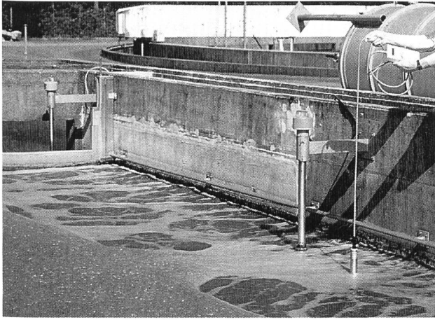
Bild 1. Messung des Feststoffgehaltes im Belebungsbecken mit Cosmos.
