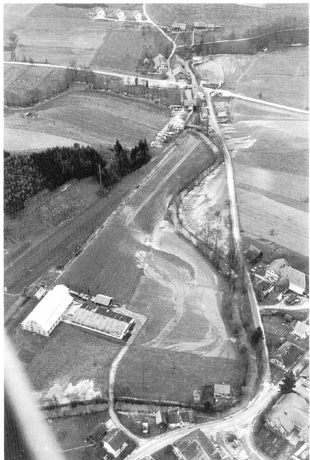
Bild 1. Luftaufnahme der Überschwemmungsspuren des Langetehochwassers vom 22. November 1972 mit einem Scheitelabfluss von 24 m 3 /s in Huttwil und 38 m 3 /s in Lotzwil (Foto Binggeli). Die Langete fliesst von Kleindietwil (unten) in Richtung Westen nach Weinstegen.
