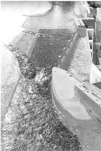
Bild 2. a) Physikalisches Modell des Entlastungsbauwerkes Lenzburg an der VAW mit Blick gegen die Fliessrichtung. Die Zulaufwassermenge Q_z beträgt 15 \text{ m}^3/\text{s} . (VAW 45/32-10). b) Hydraulische Elemente am Entlastungsbauwerk, 1. Überfallkante, 2. Sammelkanal, 3. Übergangsbereich, 4. Einlaufbereich, 5. Entlastungsstollen, 6. Buhnen.
