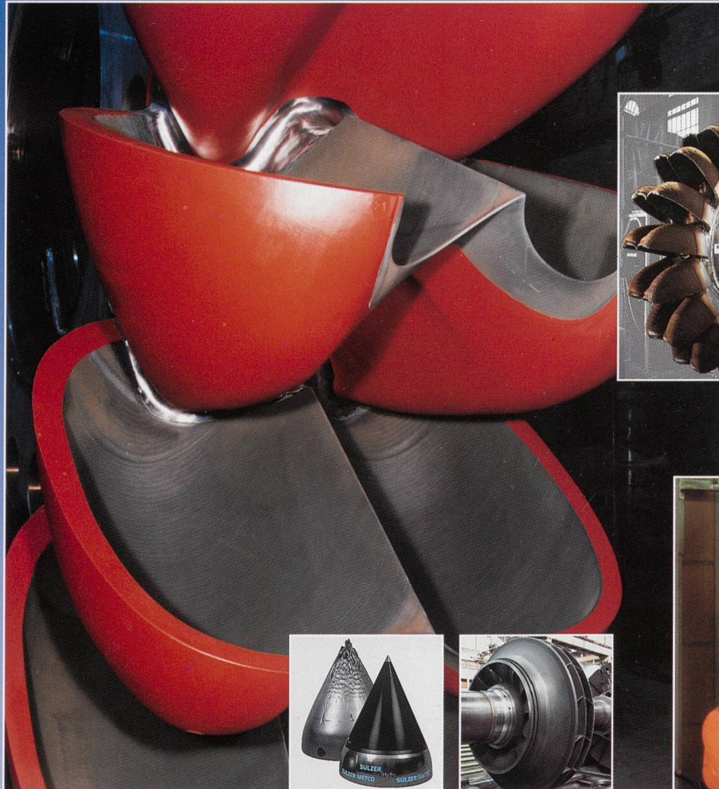
Beispiele für keramikbeschichtete Bauteile aus hydraulischen Maschinen
