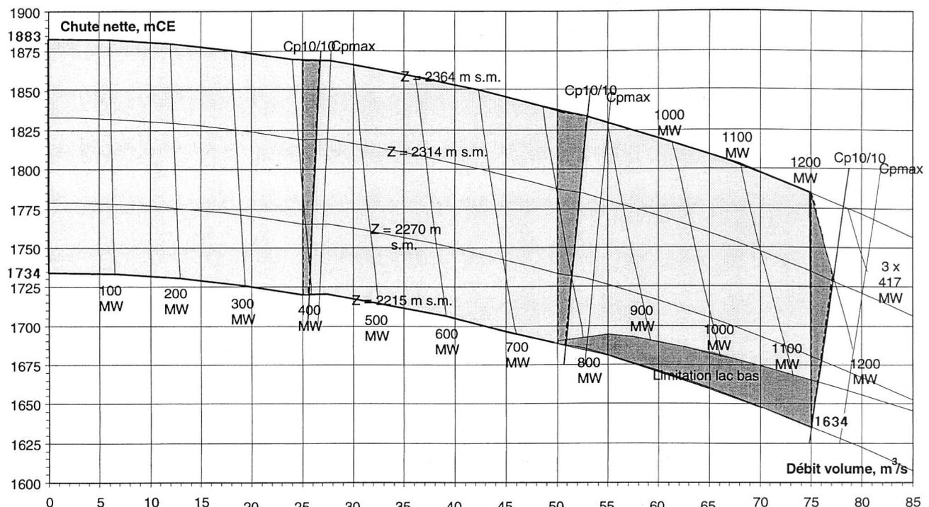
Figure 1. Domaine de fonctionnement des turbines de Bieudron.
