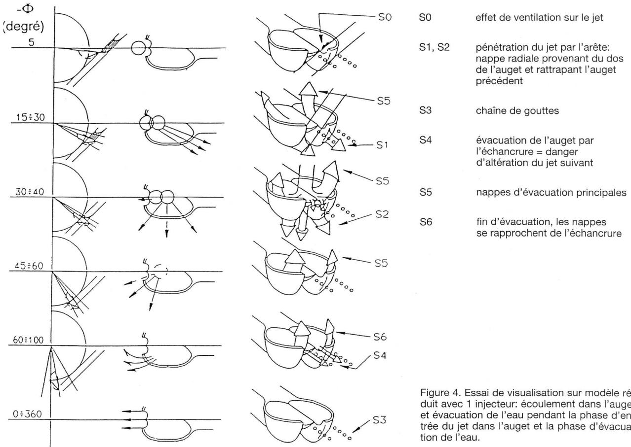
Figure 4. Essai de visualisation sur modèle réduit avec 1 injecteur: écoulement dans l'auget et évacuation de l'eau pendant la phase d'entrée du jet dans l'auget et la phase d'évacuation de l'eau.
