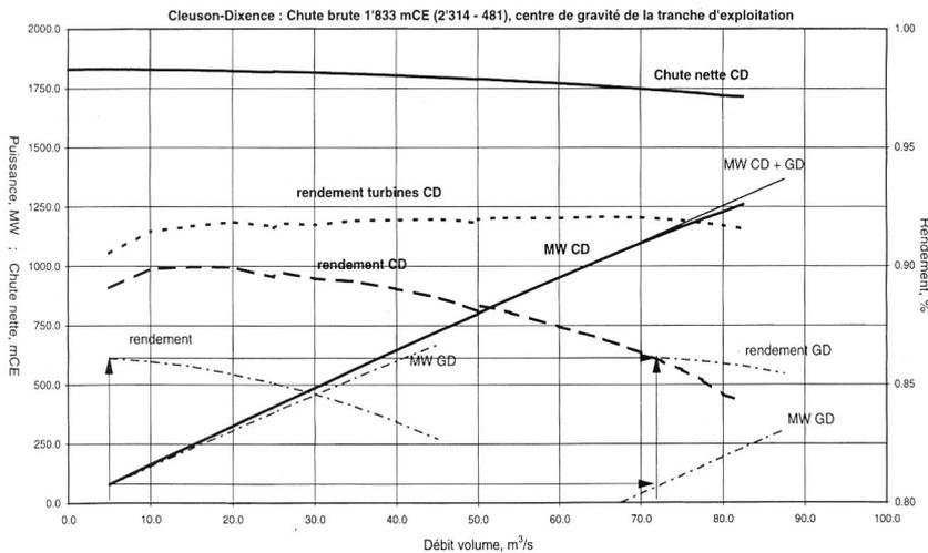
Figure 5. Caractéristiques de fonctionnement sous  $H_{brute} = 1883$  m.
