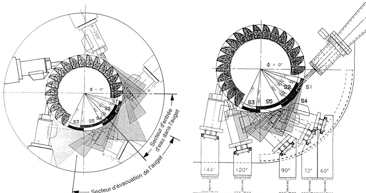
Figure 3. Situation des nappes d'évacuation, configuration 5 jets.
