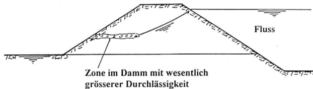
Bild 6. Erosion im Inneren des Damms, verursacht durch eine Dammszone mit zu grosser Durchlässigkeit (Filterkriterien zwischen dieser Zone und dem Damm nicht eingehalten).
