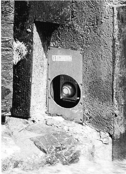
Bild 3. Ultraschallsensor unterputz montiert (Schutzabdeckung entfernt).
