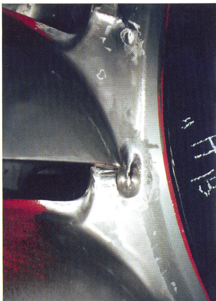
Bild 5. Ausgeschliffene Risse an einem alten Laufrad.
