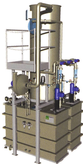
Bild 1. 3D-Darstellung des Abluftwäschers Typ RVE 1000-S mit allen erforderlichen Systemkomponenten.
